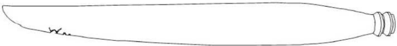
Dessin 6.4. Dommages de pale dus aux corps étrangers, qui ne peuvent pas être réparés
