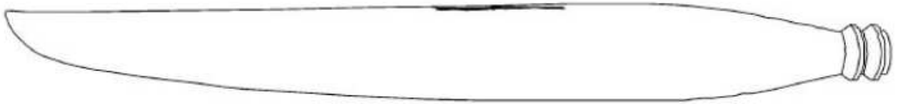
Dessin 6.2. Fissures le long du bord de fuite
