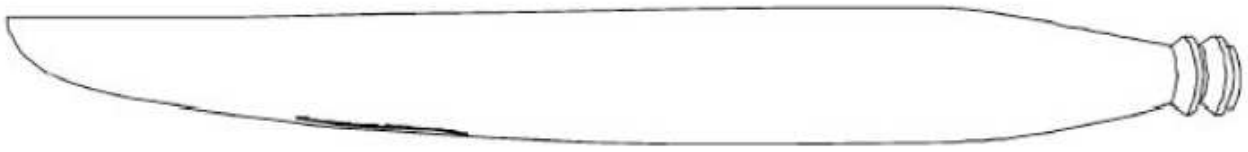
Dessin 6.1. Fissures le long du bord d'attaque
